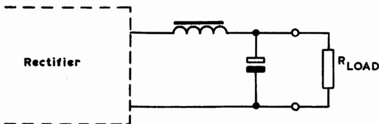
Fig. 7 : 'Choke input' filter
