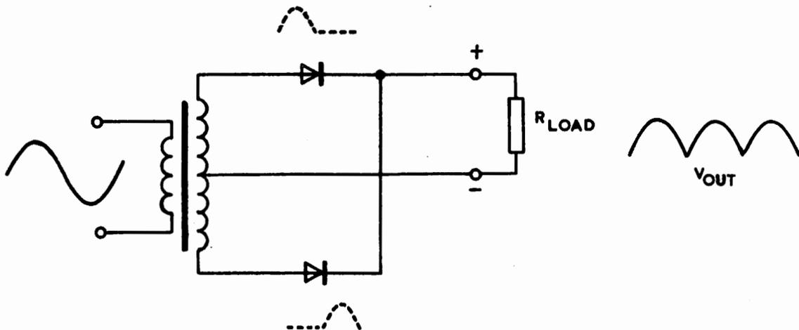
Fig. 2 : Full wave rectification
