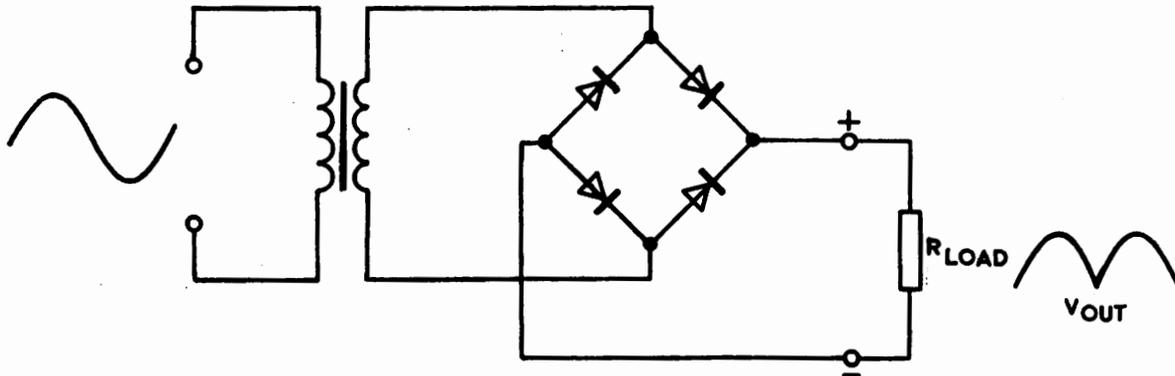
Fig. 3 : Full wave 'Bridge' rectification
