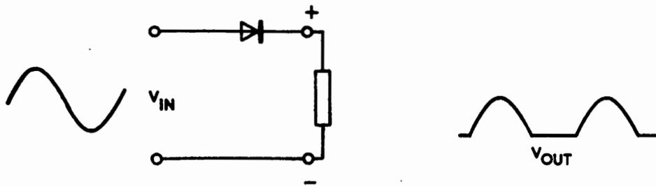
Fig. 1 : Half wave rectification
