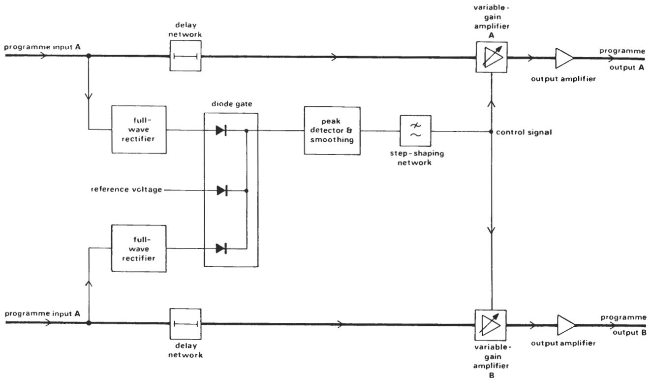
Fig. 10 Stereophonic limiter arrangement.
